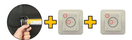
Pulse el botón de ajuste del motor (el motor pita)
